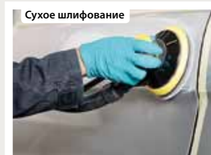
Выровняйте участок и границу перехода диском Р 1000 или Р 1200. Варианты: Q.Silver® или Polarstar. Используйте мягкий интерфейс.
